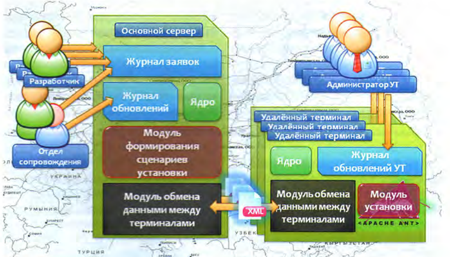
Рис. 2. Модули и схема взаимодействия Системы автоматической установки обновлений
